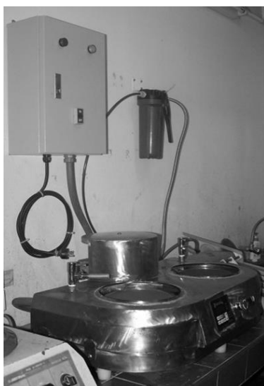
ภาพที่ 2 การประกอบชิ้นส่วนต่าง ๆ เข้ากับโครงสร้างหลักเครื่องขัดผิวชิ้นงาน, a: ด้านบน, b: ด้านล่าง
