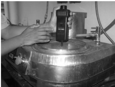
ภาพที่ 5 การทดสอบความเร็วรอบของงานขัด
