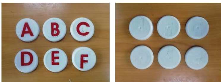
ภาพที่ 2 ตัวอย่างชิ้นยางซิลิโคนได้หวั่น (A-F) และยางซิลิโคนเยอร์มัน (ไม่มีรหัส) ที่ผสมซิลิโคนออยใน อัตราส่วนที่แตกต่างกัน
