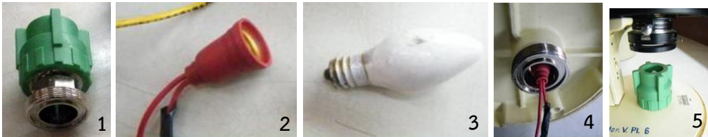
ภาพที่ 1 การยึดจับแหล่งกำเนิดแสง โดยใช้เกลียวโลหะเป็นตัวยึดจับกับฐานยึดไฟประดับต้นไม้ กับกล้องจุลทรรศน์ 1: ภาพชุดเกลียวโลหะ, 2: ฐานยึดไฟประดับต้นไม้, 3: หลอดไฟกำลังขนาด 3W, 4-5: การจับยึดหลอดไฟส่องสว่างในตำแหน่งช่องเสียบกระจกเงาเดิม ตามลำดับ
