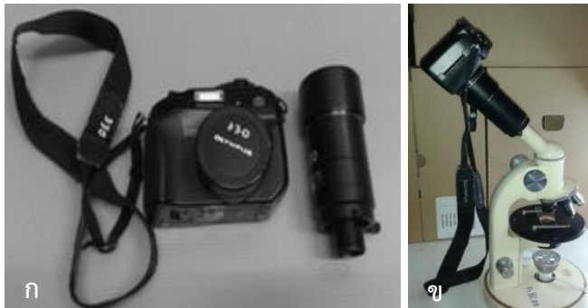
ภาพที่ 3 แสดงกล้องถ่ายภาพจากกล้องจุลทรรศน์ (ก) และการติดตั้งการถ่ายภาพจากกล้องจุลทรรศน์ (ข)
