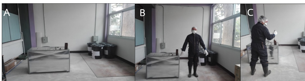
ภาพที่ 5 การจัดการด้านความปลอดภัย, A: จัดพื้นที่ทำงานเป็นสถานที่ปิด โปรง โถง และปิดคลุมเครื่องบดย่อยทุกด้าน, B: ชุดปฏิบัติงาน, C: ขณะปฏิบัติงาน
