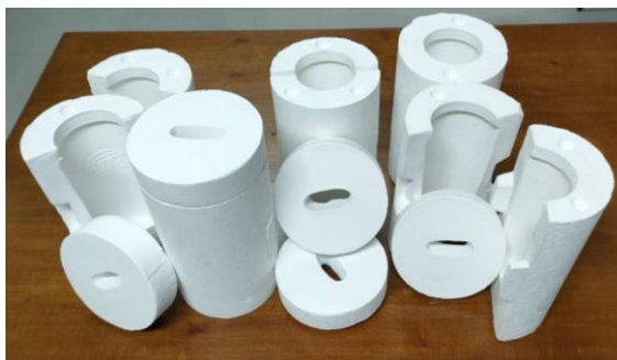
ภาพที่ 3 แบบหล่อปูนพลาสติกสำหรับขึ้นรูปแบบพิมพ์เซรามิกส์
